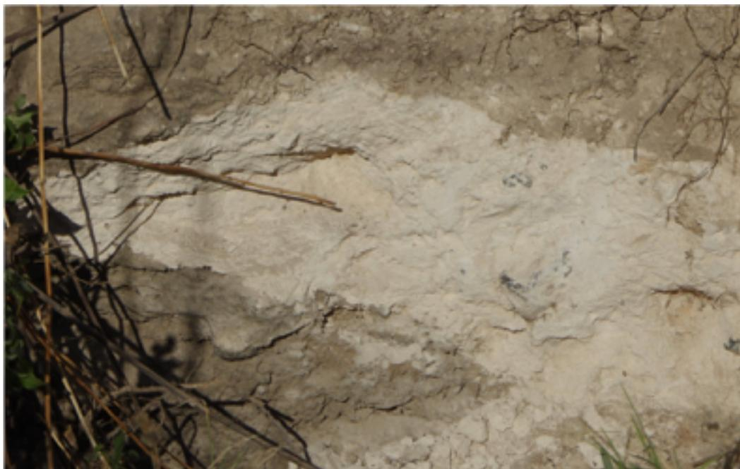
**Figura 29.** Debajo de la arcilla y con un espesor indefinido, subyace un grueso “paquete masivo”, conformado por una arenisca de grano grueso, sana y resistente (**tepetate**).
