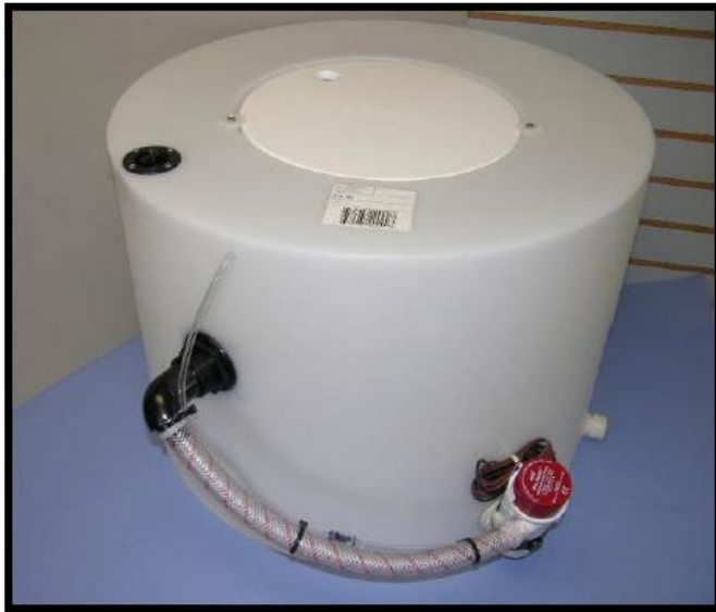
Figura 7. Tanque de conservación y transportación de peces vivos con capacidad de 300 litros, incluyendo las bombas de aire y de agua.
