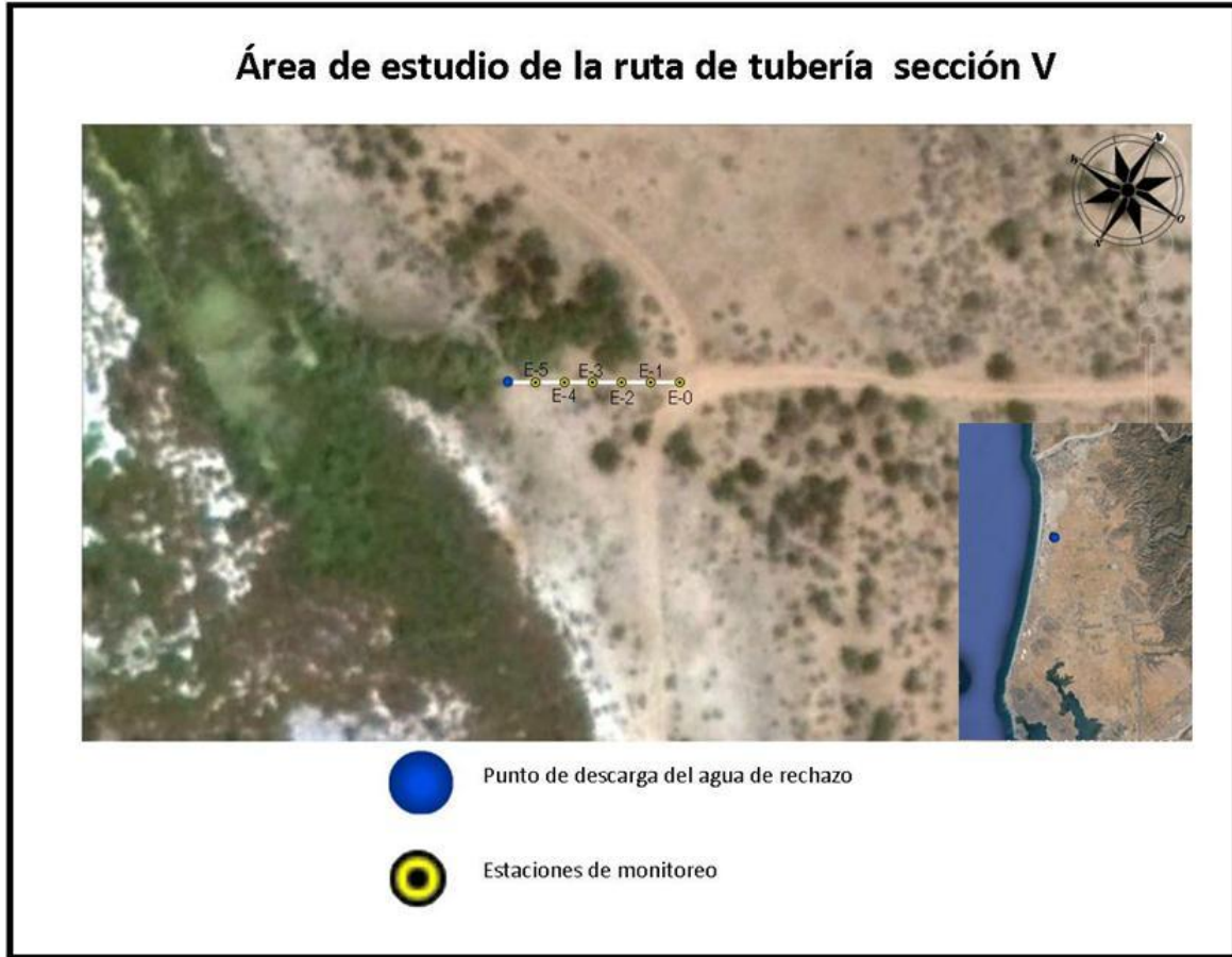
Figura 18. Imagen satelital que muestra el tramo de la Sección V de tubería donde se va a remover vegetación halófila hidrófila y las 6 estaciones (E) establecidas a lo largo del transecto de 25 m, para evaluar el área que se va a remover.
