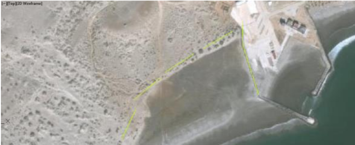
Ilustración 18. Ubicación del geotextil en zona de escollera y dunas al oeste del Parador Náutico.
