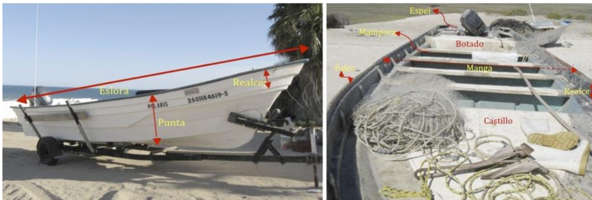
Figura II.1.1. Características físicas generales de las embarcaciones utilizadas para la pesca ribereña en el alto Golfo de California.
