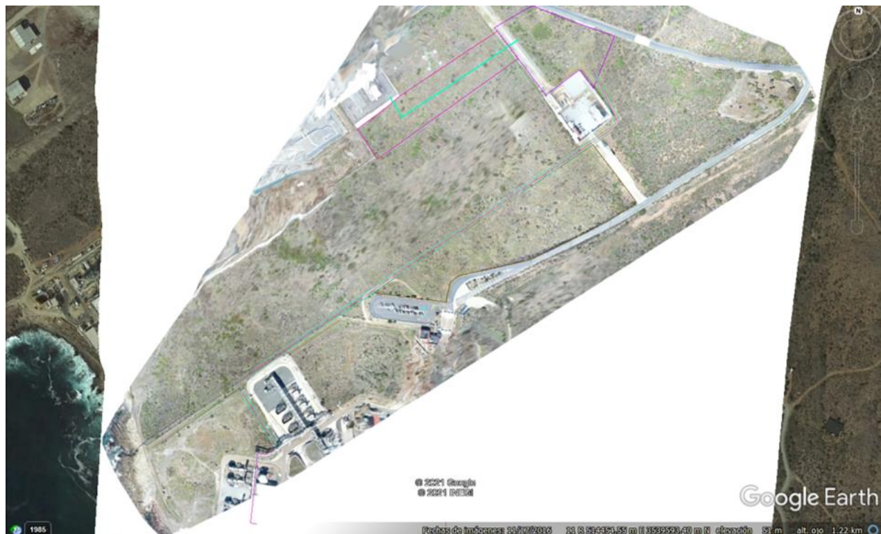
Imagen II.25. Procedimiento en un SIG para la obtención del ortomosaico generado, utilizando imágenes aéreas obtenidas en campo por medio de un Dron.
