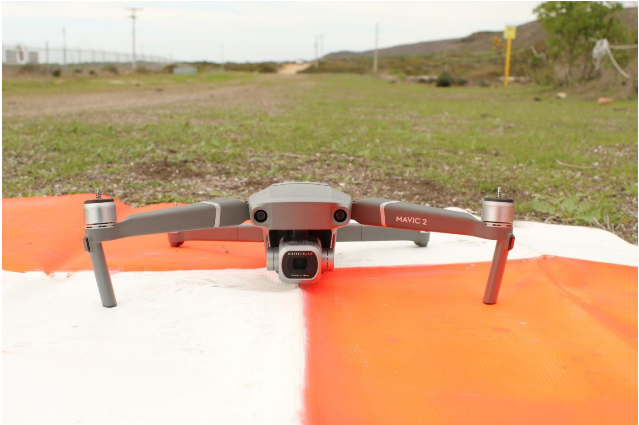
Imagen IV.39. Equipo utilizado en el levantamiento de información (Dron DJI Mavic 2 Pro).
