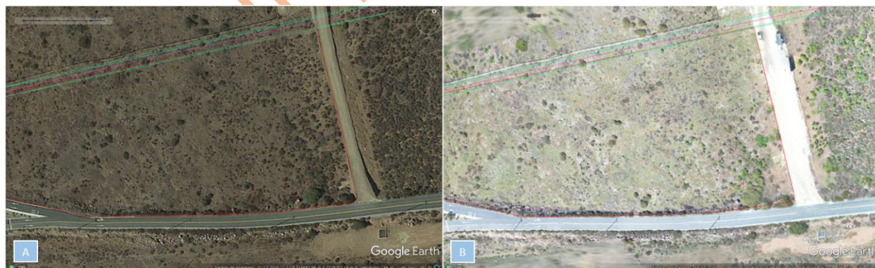
Imagen II.26. Misma ubicación diferente resolución en el área auxiliar; A) Imagen de Google Earth (2016), B) Imagen obtenida del ortomosaico generado (2021).
