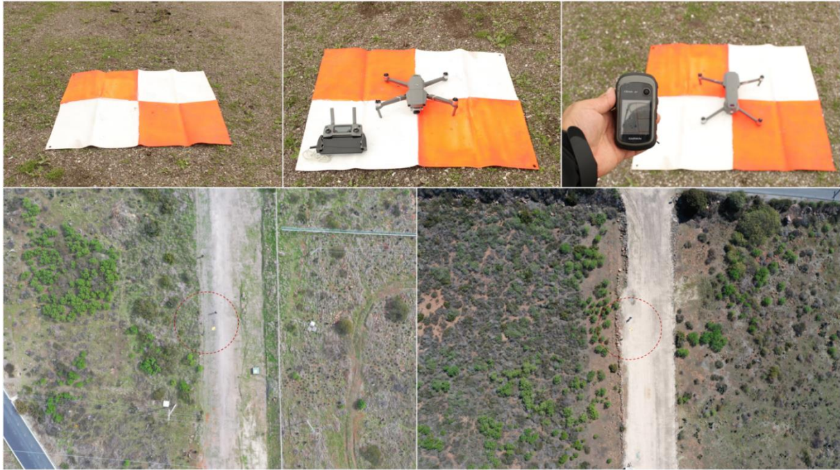
Imagen IV.41. En cada punto de despegue se tomó una coordenada con la ayuda de un GPS y posteriormente se tomó una fotografía aérea vertical con el Dron para tener una referencia espacial ubicando una diana de control.
