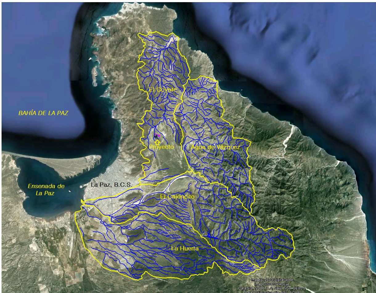
Figura IV-23. Microcuencas de los escurrimientos superficiales efímeros más importantes del área de estudio. El Proyecto se ubica en la parte alta de la microcuenca del Arroyo El Coyote.
