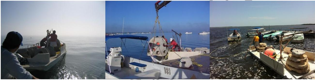
Figura 13. Plataforma modificada y equipada con polipasto o malacate para el traslado de estructuras de mayor peso a la zona de inmersión.
