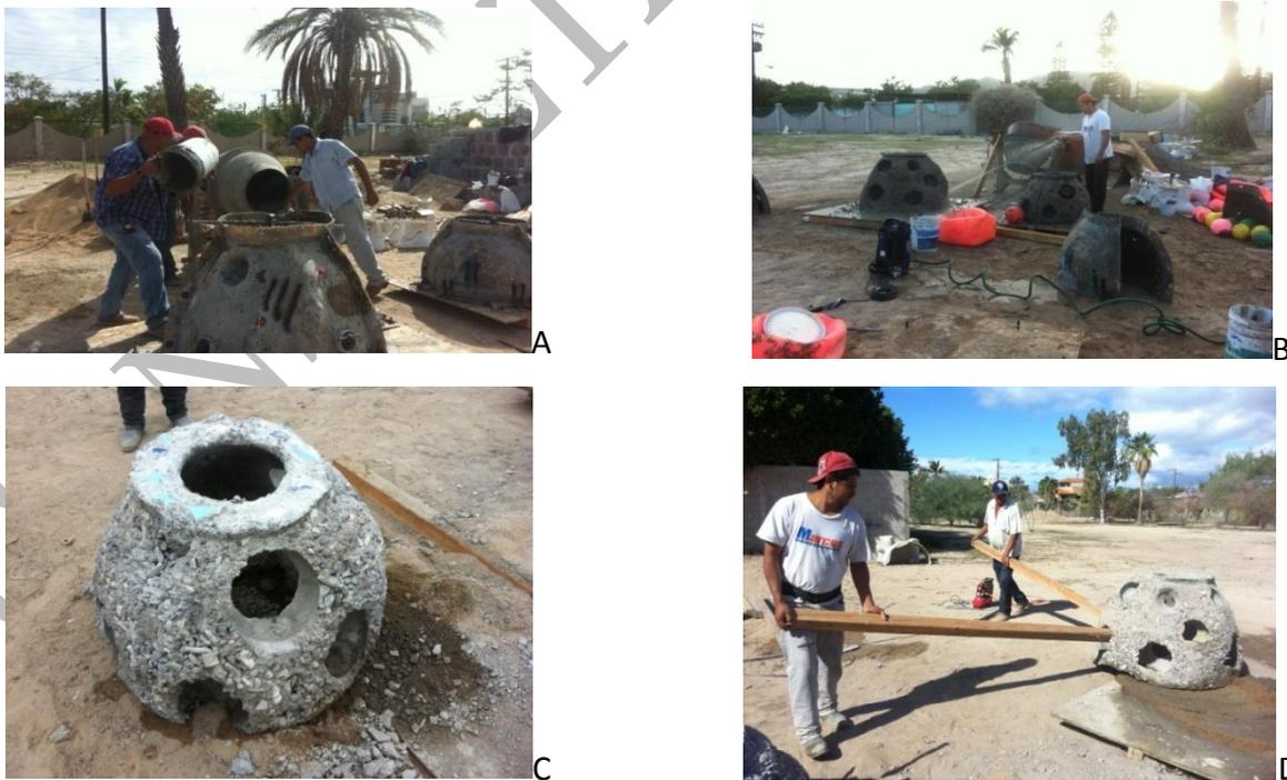
Figura 2. Fabricación de Reef Ball A) Colado. B) Curado. C) Estructura seca. D) Movilización manual comprobando la resistencia al manejo.
