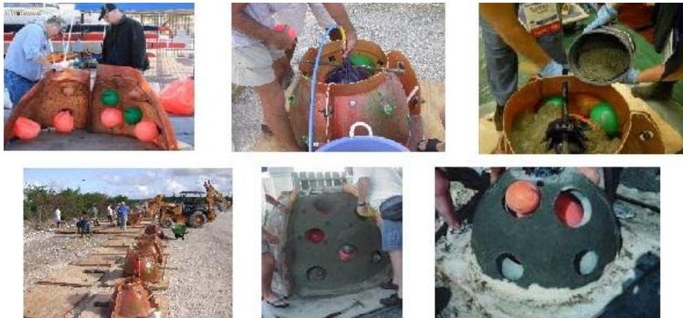
Figura 10. Proceso general de construcción de un Reef Ball usando moldes y globos de polyform.
