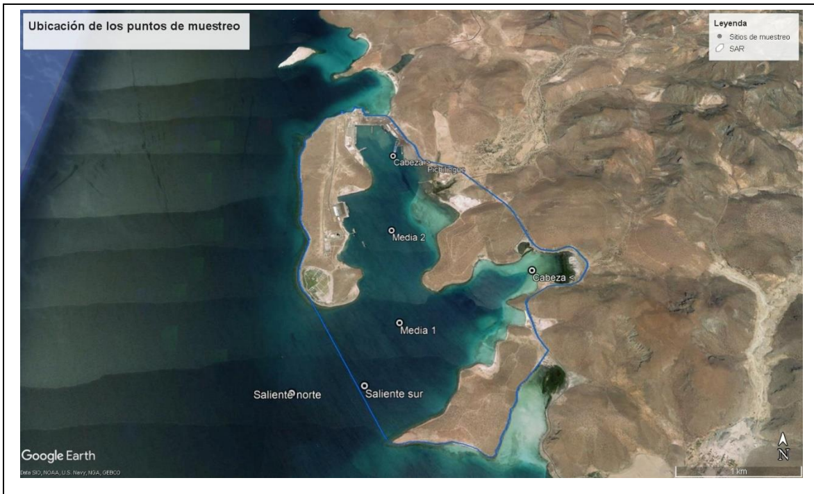
Figura IV-60. Ubicación de los sitios de muestreo de agua y sedimentos en la bahía de Pichilingue, con respecto al SAR definido para el proyecto, para determinar su calidad, granulometría y presencia de bentos.
