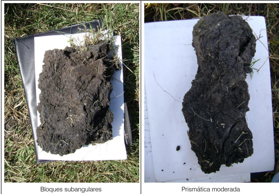
Figura IV-43. Tipos de estructuras de un suelo.
