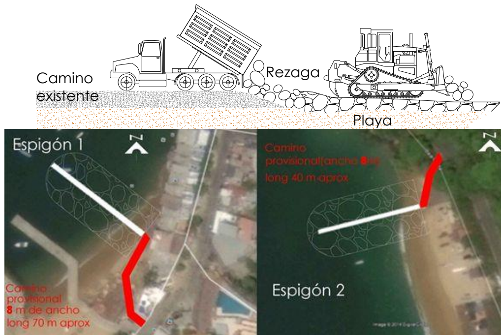
Figura II.8 Descarga y acomodo del material de rezaga para construcción de caminos provisionales sobre la playa para maniobrar para la construcción de los espigones.
