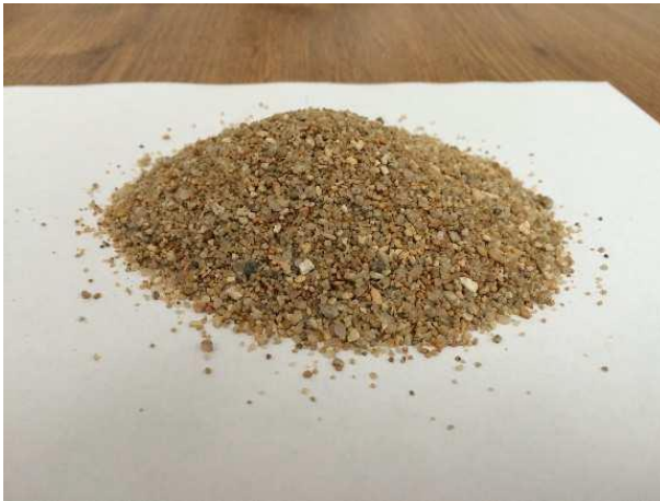
Figura II.9.b.- Arena de textura gruesa mal graduada (SW); playa de bahía de Puerto Marqués.
