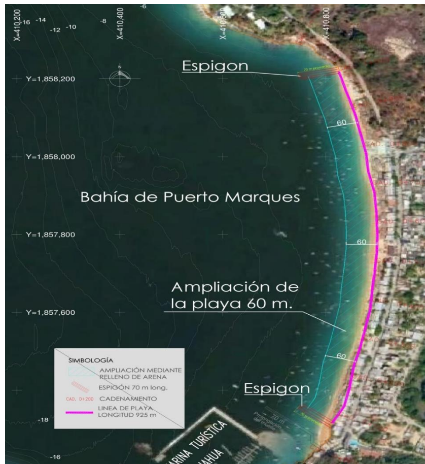
Figura II.1 Planteamiento conceptual del proyecto de reposición de la playa confinada lateralmente por espigones de enrocamiento.
