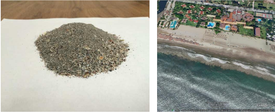
Figura II.9.b.- Arena limosa de textura fina y color gris; playa el Revolcadero.
