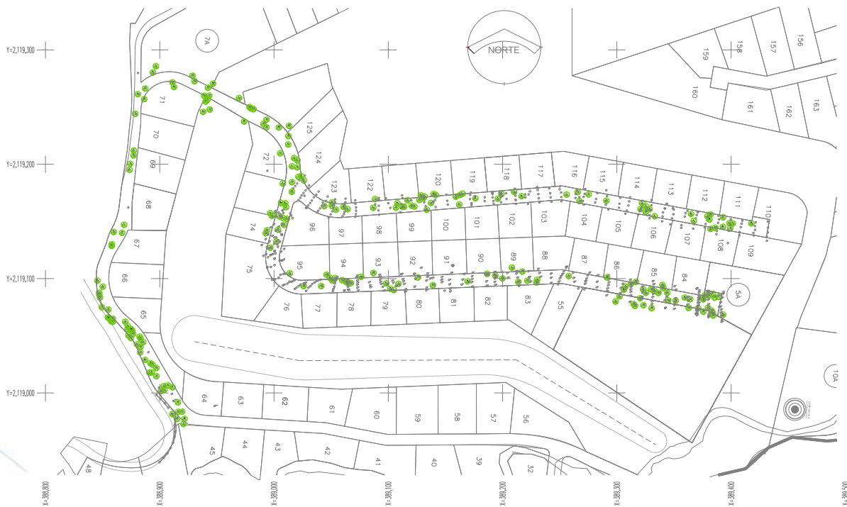
Imagen II. 25. Identificación de árboles afectados por construcción de la etapa 2 en el Rancho Avándaro.
