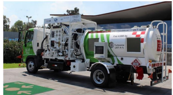
Figura II-25. Sistema de suministro de combustible a aeronaves ( Into-plane ).
