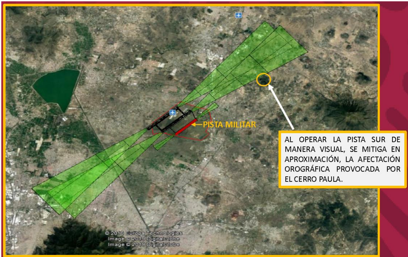
Figura II-15. Análisis sobre la presencia del Cerro de Paula como superficie limitadora para la aproximación de aeronaves en el Proyecto del AISL.
