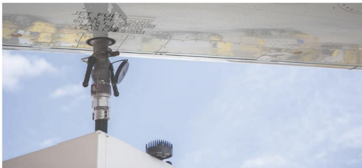
Figura II-25. Sistema de suministro de combustible a aeronaves ( Into-plane ).
