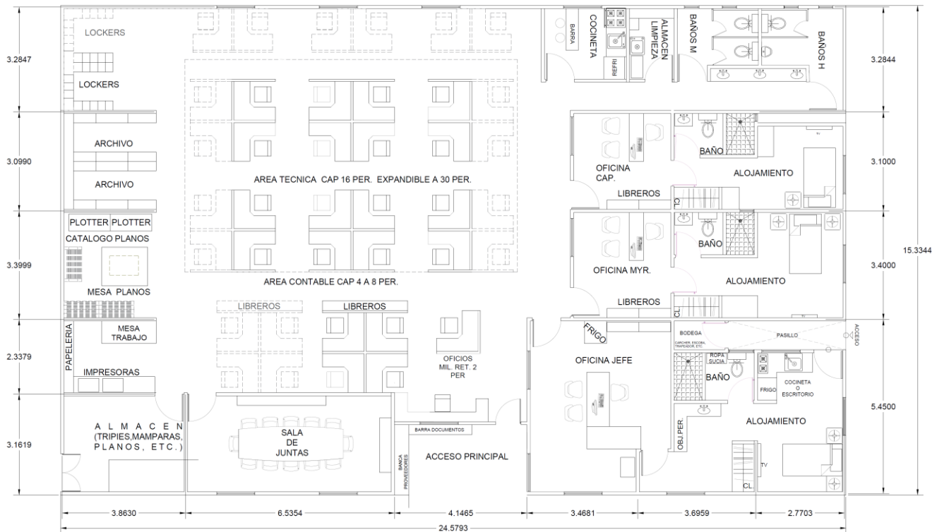
Figura II-14. Prototipo de oficinas provisionales para la etapa de construcción del Proyecto del Aeropuerto Internacional de Santa Lucía.
