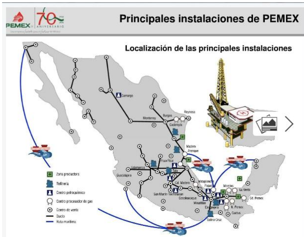
Figura V.6. Infraestructura de hidrocarburos en el país.
