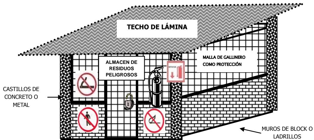
Imagen 2.29. Características del almacén de residuos y sustancias peligrosas.
