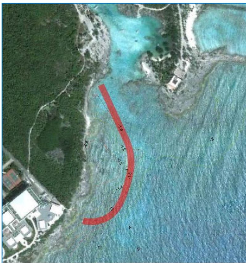
Figura 6. Batimetría original, arrecife artificial sobrepuesta.
