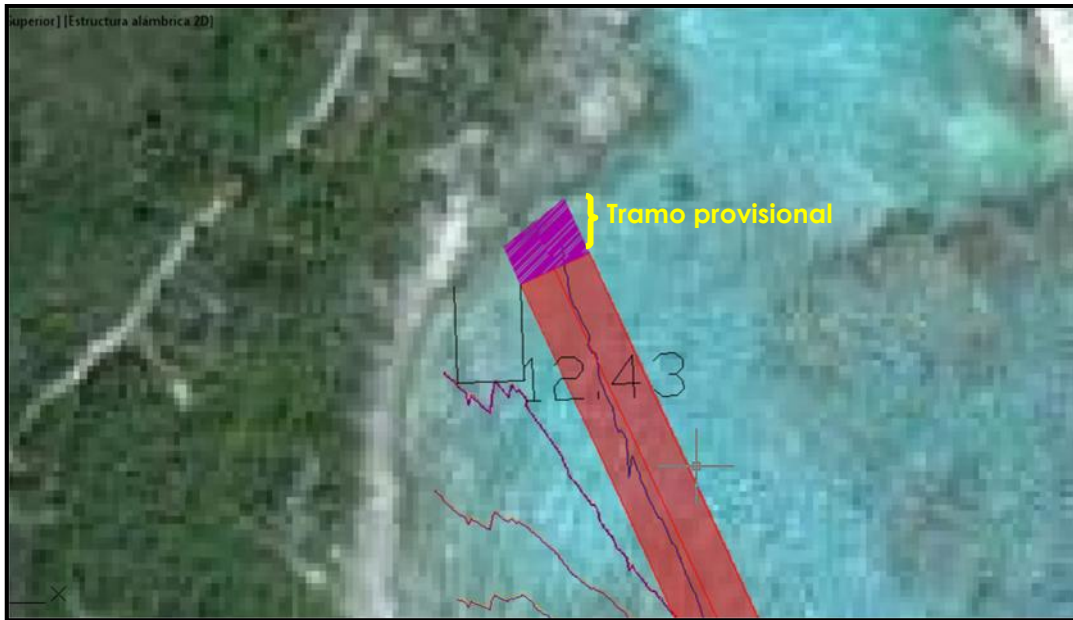
Figura 51. Tramo provisional para la construcción del arrecife artificial.
