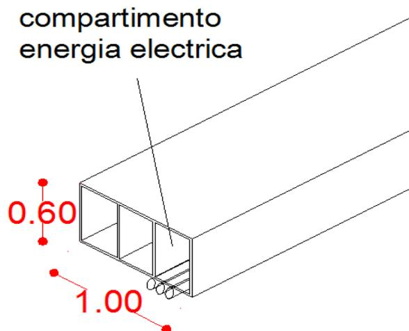
Figura 2.11.-Ubicación de línea eléctrica en trinchera
