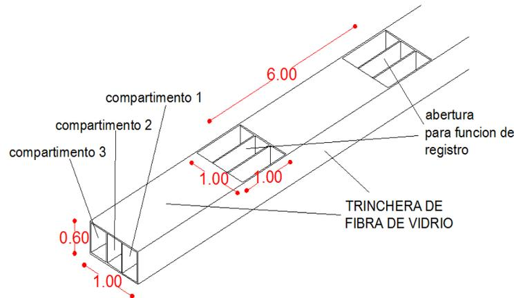
**Figura 2.9.-**Trinchera hermética de fibra de vidrio
