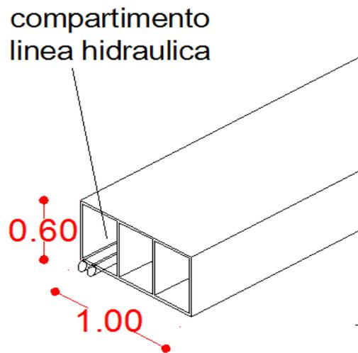
**Figura 2.12.-** Ubicación de línea hidráulica en trinchera
