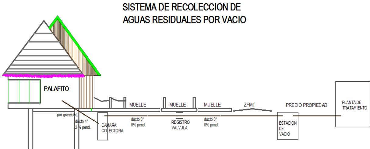
**Figura 2.13.-** Sistema de recolección de aguas residuales por vacío.
