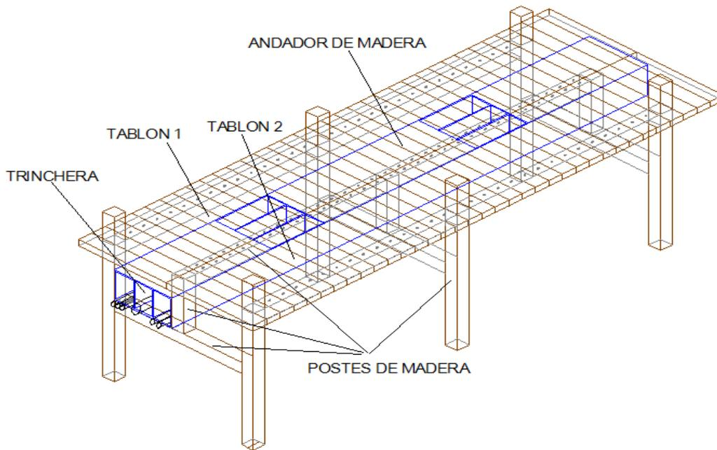
Figura 2.10.-Ubicación de trinchera hermética
