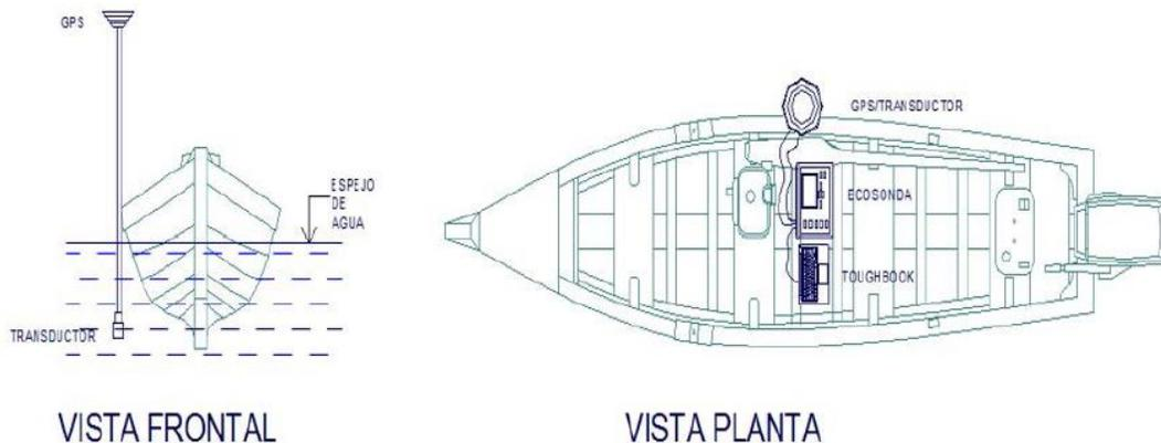
**Figura 4.51.-** Instalación de equipos para realizar batimetría.
