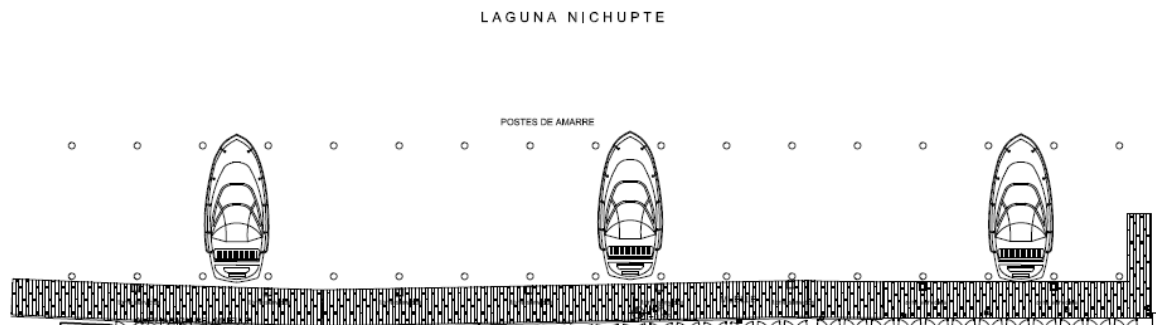
Figura II.7 Esquema de cómo estarán los postes de amarre y los muelles flotantes.
