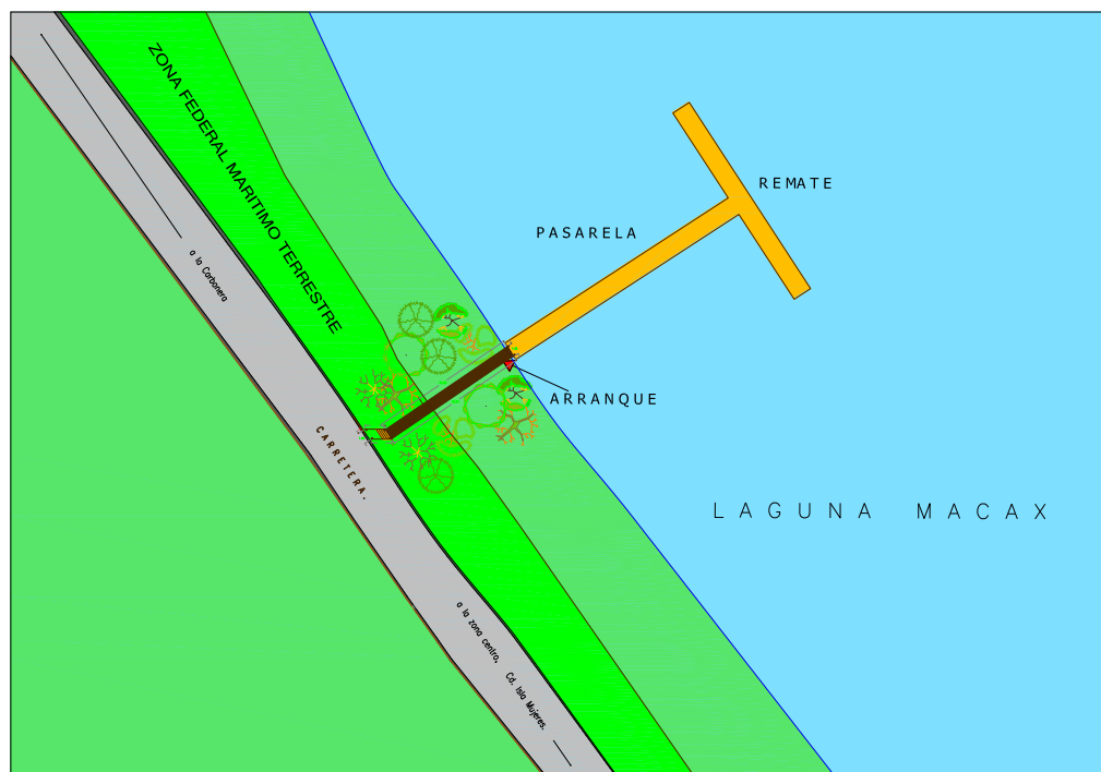
Imagen que muestra el desplante de la infraestructura rústica en madera de la plataforma de acceso y arranque en Zona Federal, así como el muelle sobre el espejo de agua lagunar.
