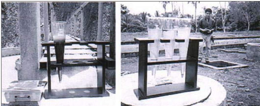
Foto 2.20 Conos de Imhoff para determinar los sólidos sedimentables en el agua residual.
