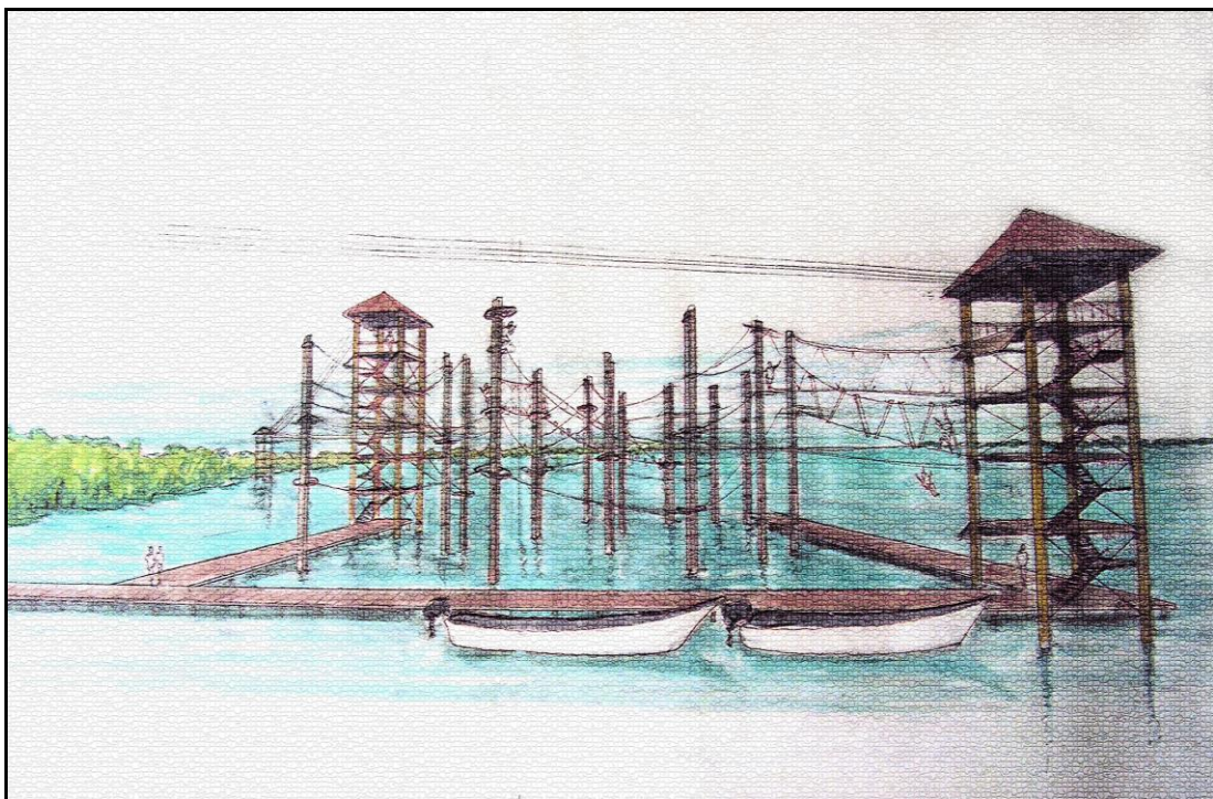
Se muestra una perspectiva de las dos torres de madera para el desarrollo de la zona de tirolesas y los juegos de cuerdas, que aprovechan el muelle preexistente ya reparado.
