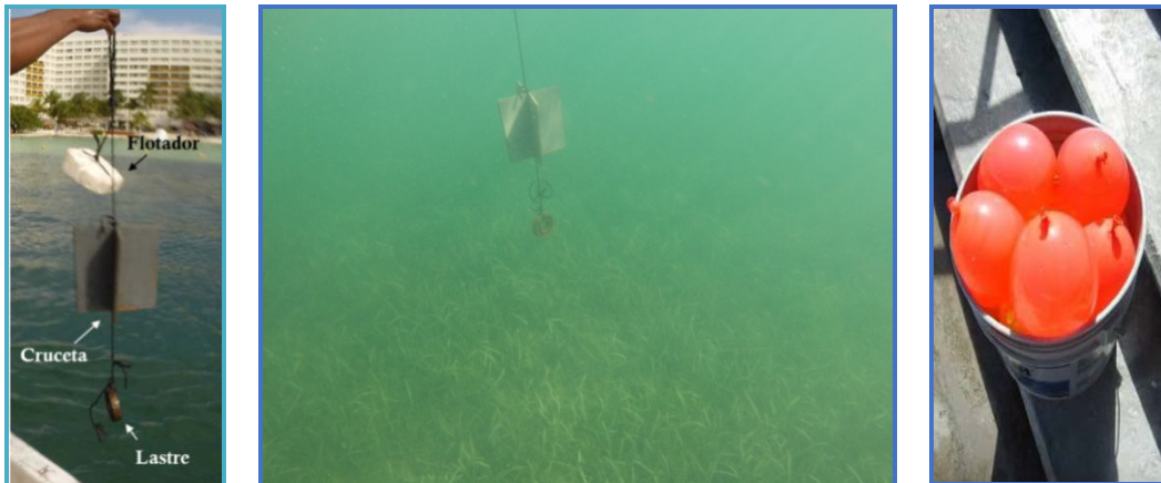
Figura IV_9.- Fotos de crucetas de deriva y globos rellenos con agua usados en las mediciones de las corrientes.
