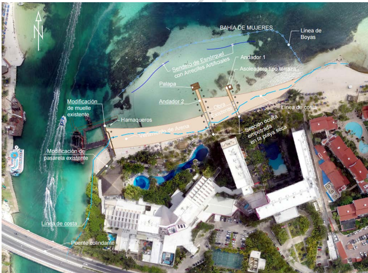
Figura II_ 13. Obras a realizar en el proyecto.
