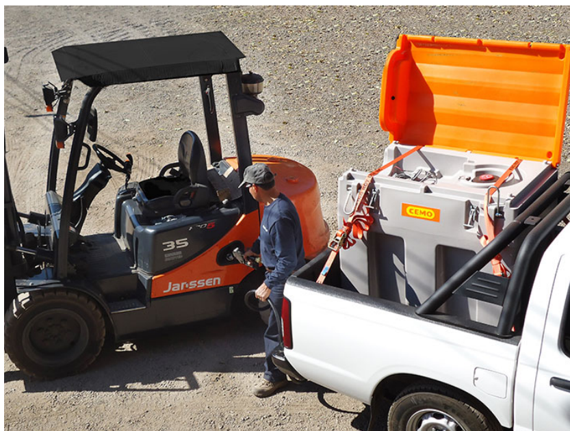
Imagen II.7.- Vehículo con bomba de gasolina portable
