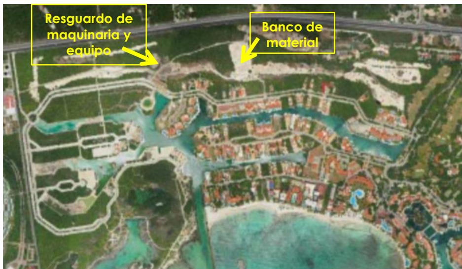
Figura 48. Área designada para almacenamiento y uso de rocas, guardar maquinaria pesada y recibir, almacenar los AAM.
