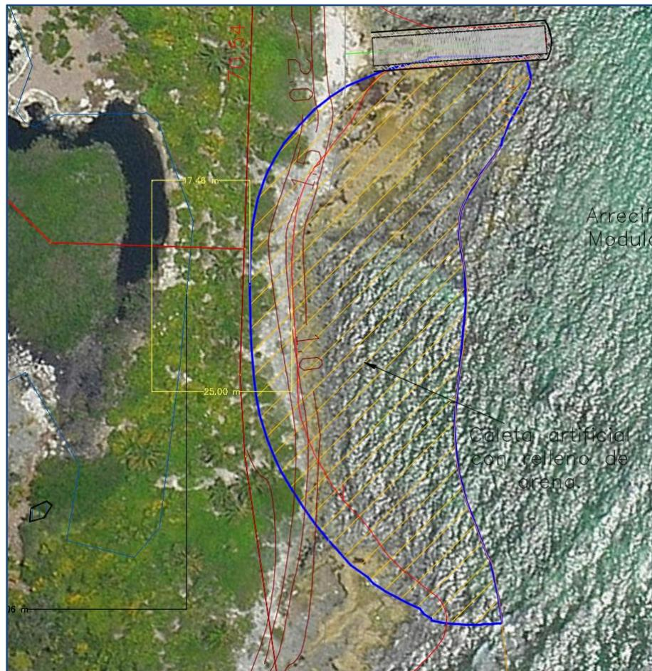
**Figura 46.** La línea azul señala el polígono a excavar para conformar la playa artificial.
