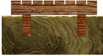
Figura II.21. Pasos a playa con decks de madera sobre pilotes hincados en el terreno.
