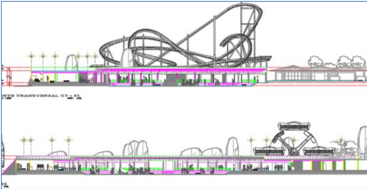
Figura II-28. Cortes del edificio central se observa la altura de los juegos mecánicos que será máximo de 25 m.
