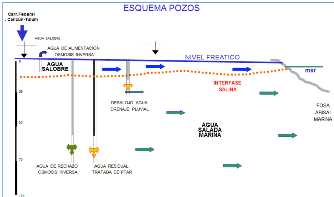
Figura IV-26. Esquema del funcionamiento del acuífero y la recomendación para construir los pozos.
