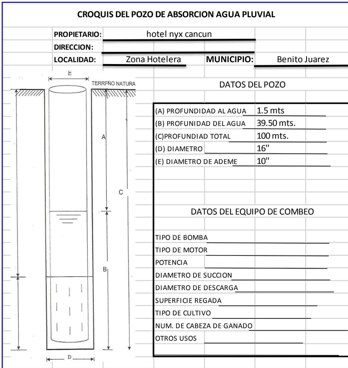
Los pozos tendrán mantenimiento periódico según lo establecido en la **NOM-004-CNA-1996**, “Requisitos para la protección de acuíferos durante el mantenimiento y rehabilitación de pozos de extracción de agua y para el cierre de pozos en general”.
