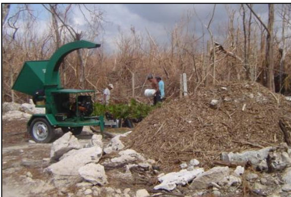
La imagen corresponde a un modelo de trituradora de materia vegetal que sería utilizado; los residuos triturados serán esparcidos en las áreas que se conservarán con vegetación natural y también en donde se realizará el zocoleo para enriquecer el suelo.
