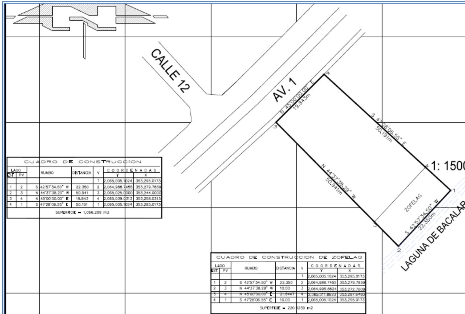
La imagen es sólo una referencia, se adjunta al presente estudio, en calidad de anexo documental el plano del levantamiento topográfico realizado con Estación Total SET 630R, marca SOKKIA, para la liga del polígono con el vértice de INEGI se utilizó GPS Garmin. \* Para detalles del plano favor de ver anexos.
