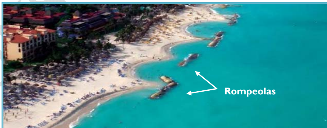
Figura II_ 18. Ejemplo de rompeolas paralelos a la línea de costa.
