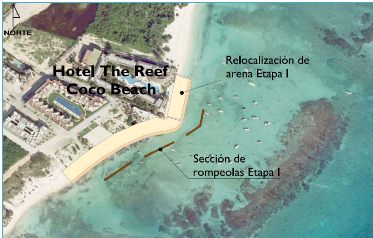
Figura II_ 17. Obras de la Etapa I del proyecto.
