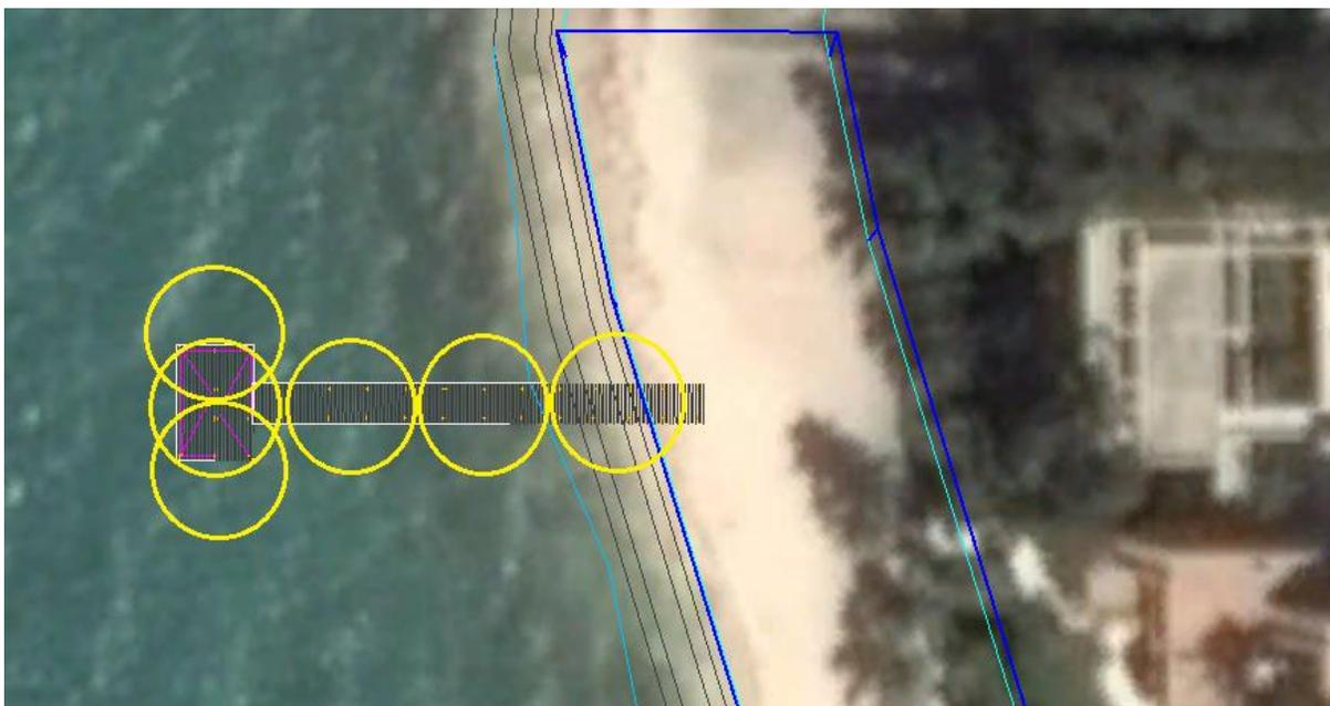
Como se observa en la imagen, la malla antidispersante será colocada en círculos y como vaya avanzando el hincado de los pilotes, esta será retirada y colocada en las nuevas áreas de trabajo.
