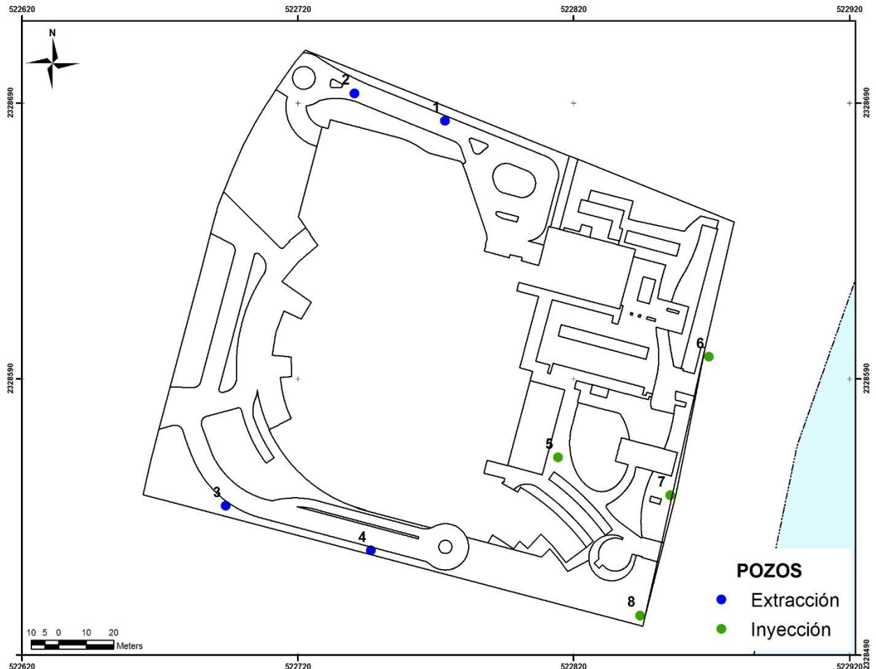
Figura 2. 31. Ubicación de los pozos de extracción (1 al 4) y de los pozos de inyección (5 al 8) para el proyecto Kukulkán 55.
