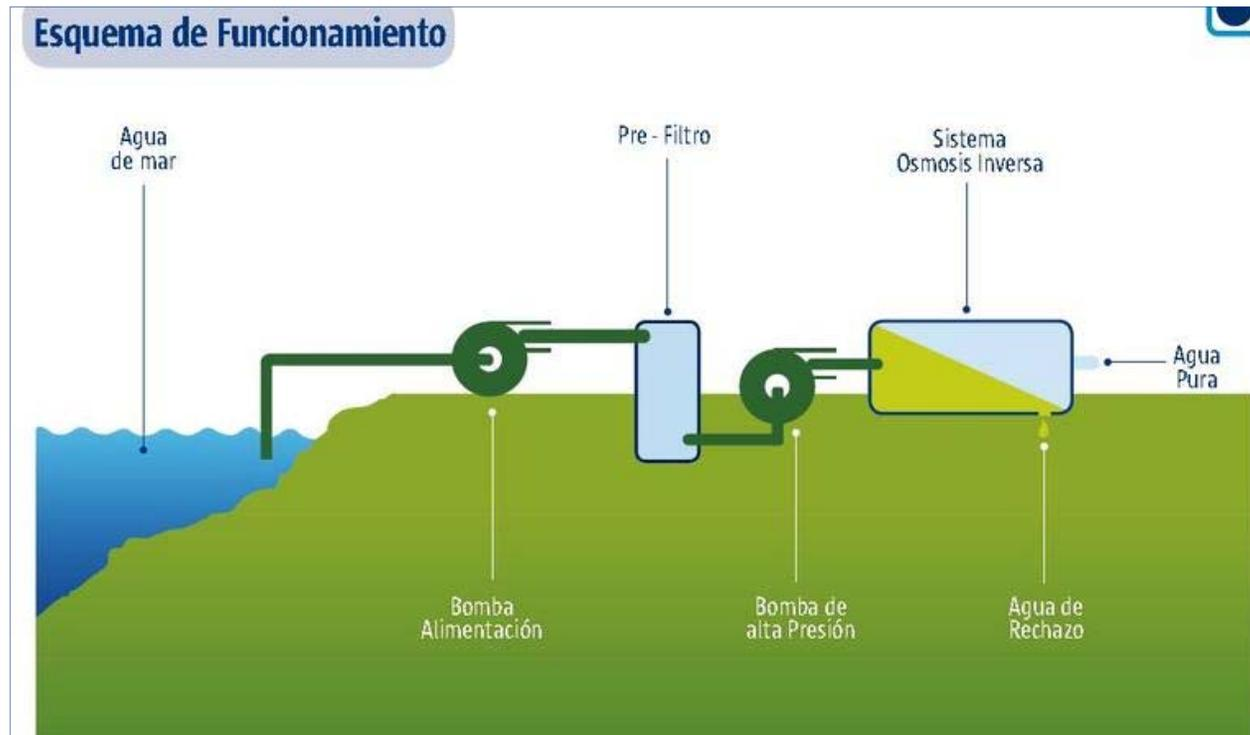
**Figura 13.-** Diagrama de funcionamiento del proceso de ósmosis inversa (OI).
