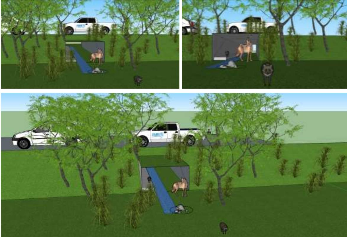
**Figura VI.15. Pasó inferior para fauna silvestre, a través de la sustitución de tubos de concreto por losas, estas estructuras son utilizadas por una gran variedad de animales, y se ven atraídas a ellas por la amplitud y gran cantidad de luz natural que estas proveen. En los gráficos se pueden observar el sistema de drenaje y la adecuación del paso seco.**
