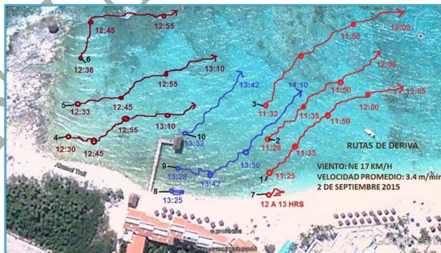
Figura IV_21.- Mediciones de la corriente superficial en el área del proyecto
