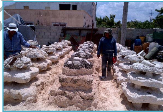
Figura II_ 44. - Fabricación de arrecifes en el patio de colado.
