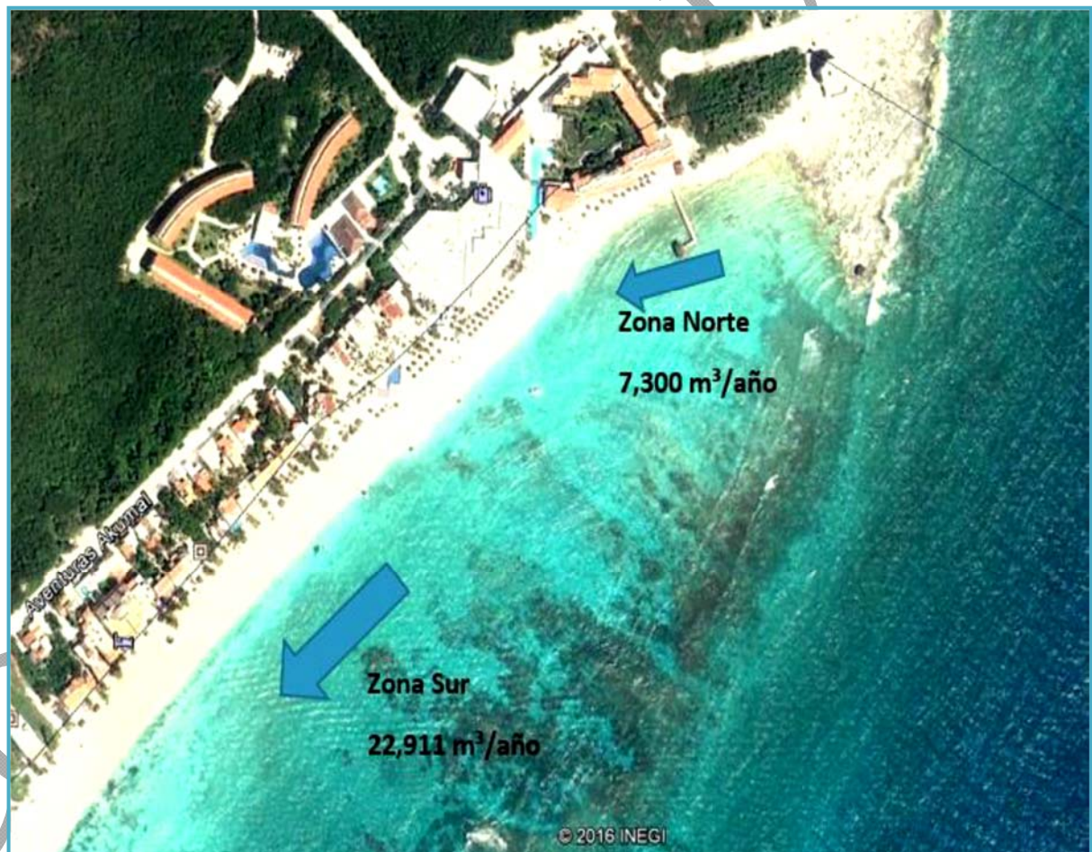
Figura IV_26. Resultados del potencial de transporte por el método del Kamphuis en Oasis Tulum.
