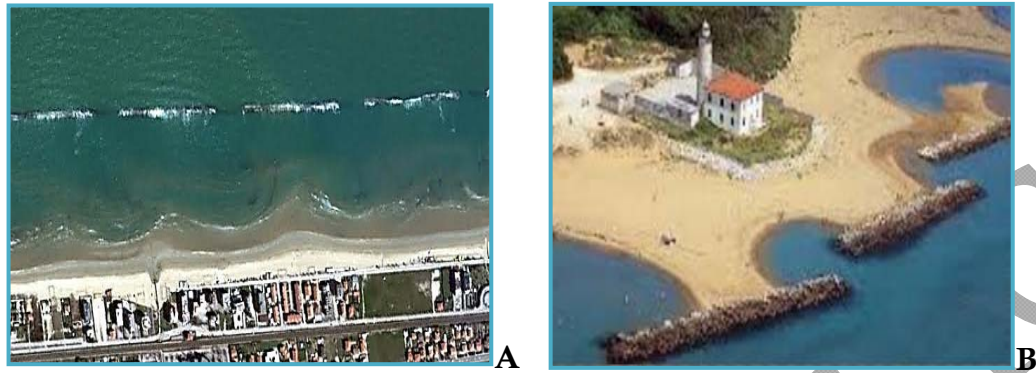
Figura II_ 11. Ejemplos de respuesta de playa con rompeolas paralelos (A Salientes, B tómbolos).
