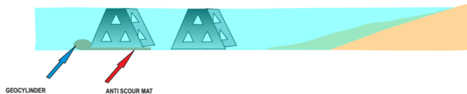
Figura 30. Descripción esquemática de los AMA® y del anclaje que será utilizado
