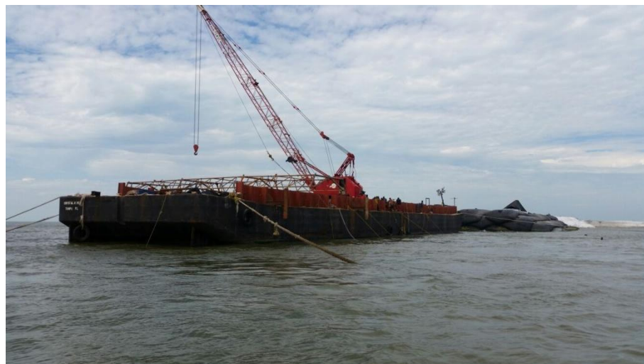
Figura 28. Ejemplo de la barcaza que será utilizada para la colocación de los AMA® en el sitio de pretendida ubicación del proyecto.
