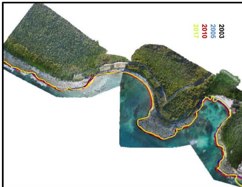
Figura IV.4. Línea de costa de los años 2003, 2005, 2010 y 2017 ajustadas a partir de imágenes satelitales calibradas y adquiridas de la base histórica de Google Earth y fotogrametría de Tecnoceano.
