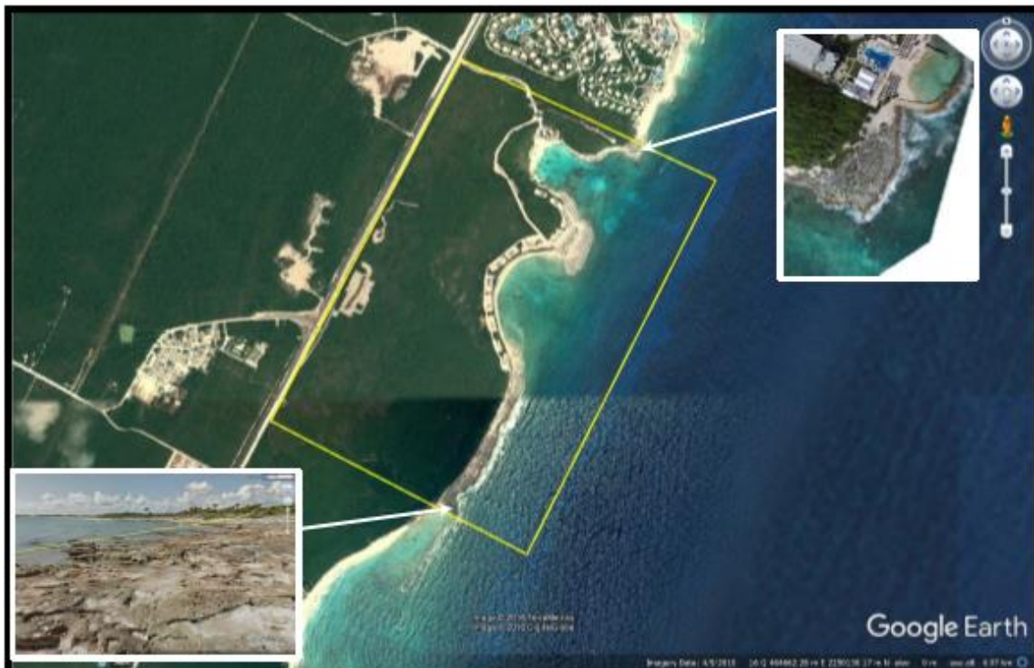
Figura IV.2. El recuadro amarillo muestra la celda litoral independiente. Los límites de la celda se deben a zonas totalmente rocosas más una estructura en el límite Norte. La salida del sedimento es hacia aguas profundas.
