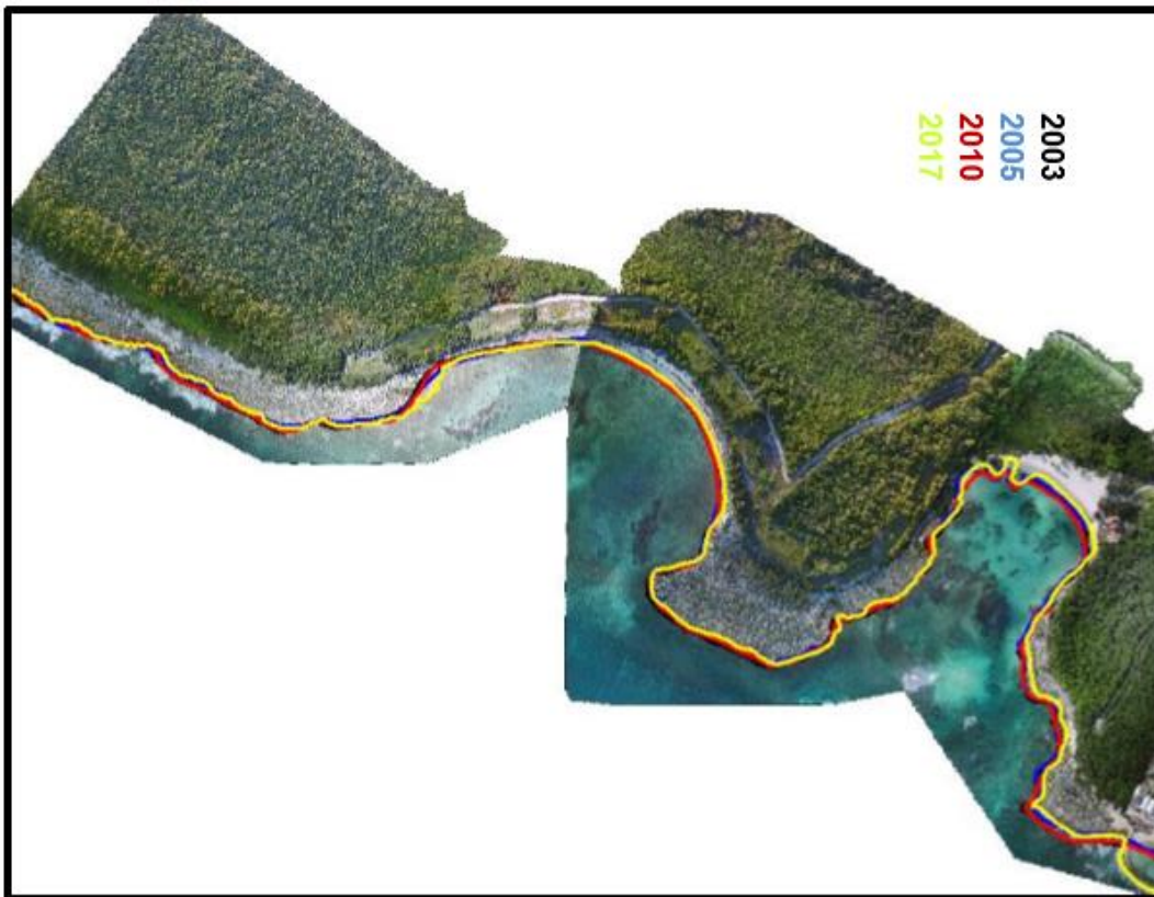
Figura IV.7. Línea de costa de los años 2003, 2005, 2010 y 2017 ajustadas a partir de imágenes satelitales calibradas y adquiridas de la base histórica de Google Earth y fotogrametría de Tecnoceano.
