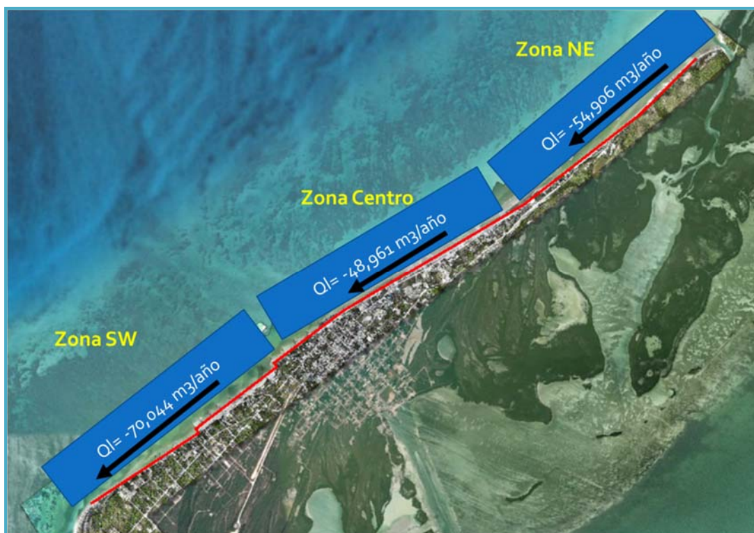
Figura IV_ 27. Resultados del potencial de transporte por el método del CERC en la Isla Chica, Holbox.
