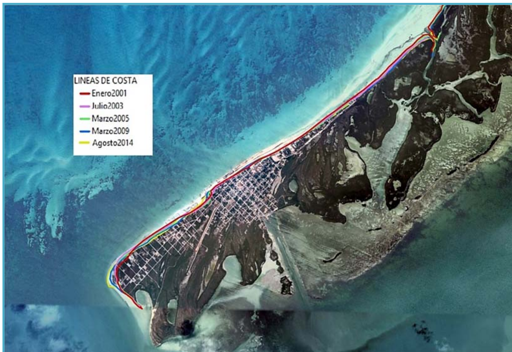
Figura IV_ 25. Digitalización de las líneas de costa de la isla Holbox.
