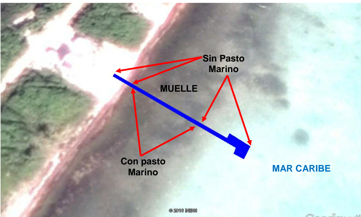
Fig. 36.- Representación gráfica de las áreas sin pasto y con pasto marino por la que atravesará el muelle de madera.
