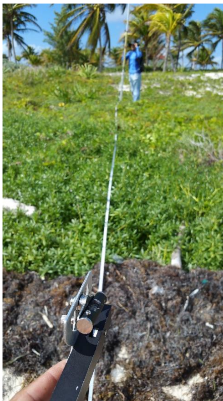
Figura 79. Equipo utilizado para levantamiento topográfico: estadal, cinta métrica e hipsómetro.
