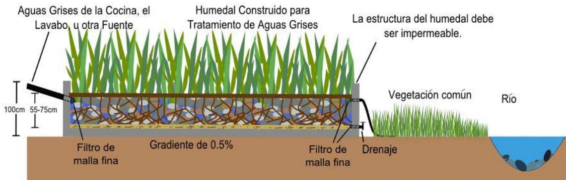
**Figura 2.23.-** Estructura de Humedal artificial propuesto para tratamiento de aguas del proyecto.
