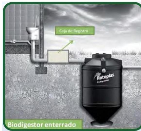
**Figura 2.17.-** Descripción del biodigestor.
