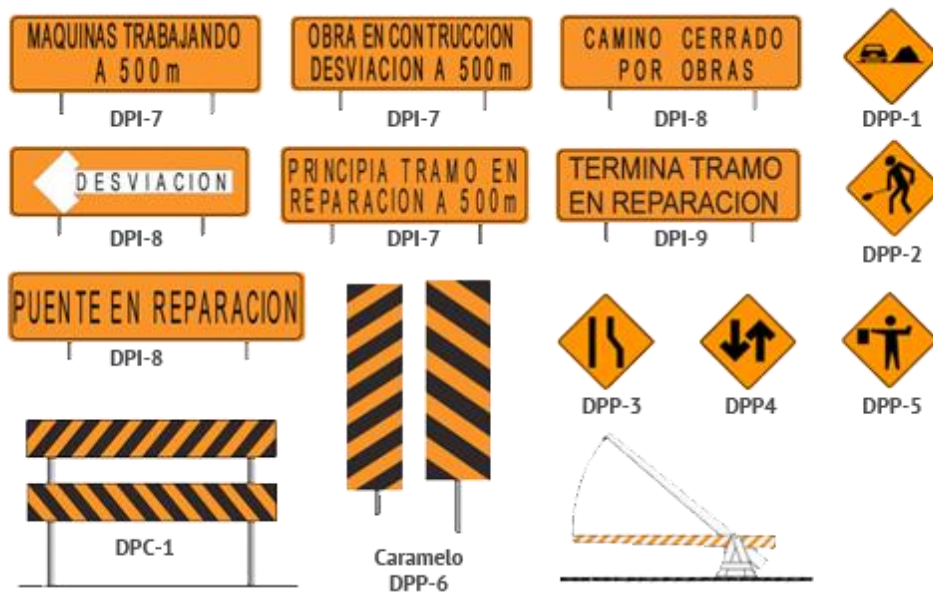
Figura 6.14. Ejemplos de señales preventivas utilizadas durante la obra del proyecto.
