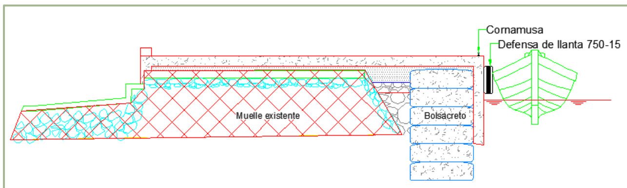
Figura II. 11. Cornamusas y defensas de llanta de camioneta.
