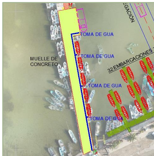
Figura II. 13. Red de agua potable.
