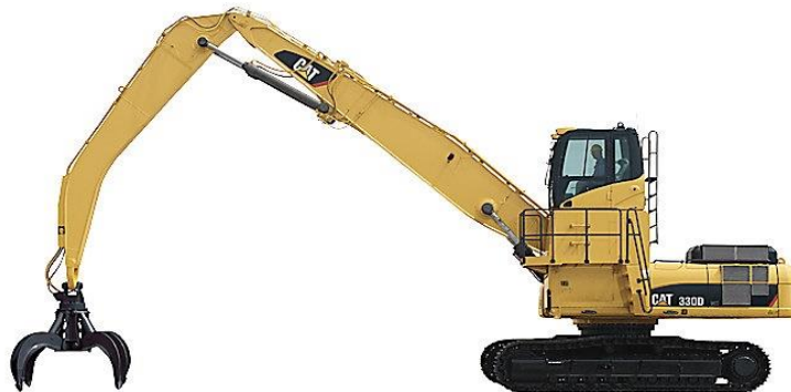
Fotografía II. 5. Maquina manipuladora de materiales CAT.
