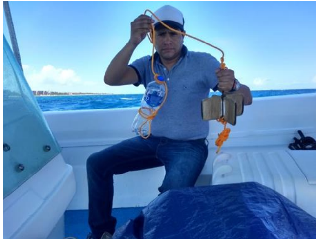
Figura IV-49. Veleta para medición de corrientes
