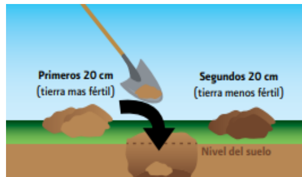
Figura VI-11. Apertura de cepa común para plantación.
