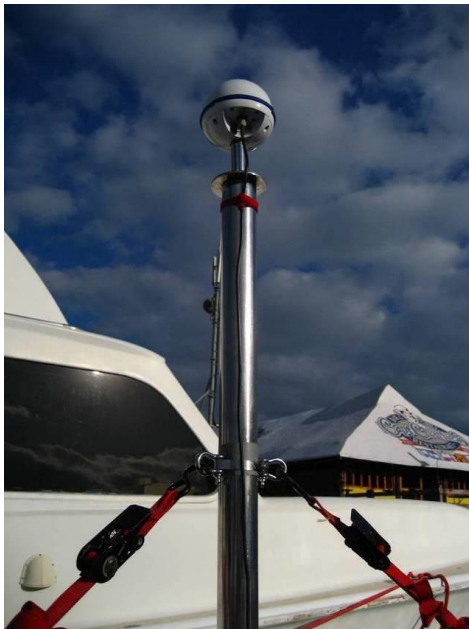
Figura 28. Antena para GPS arriba de los obstáculos de la embarcación.
