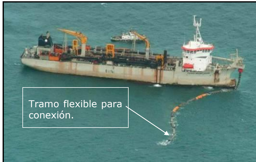
Figura 41a. Draga conectada a la manguera flotante por medio del tubo de expulsión en la proa, previa al vertimiento en la playa.
