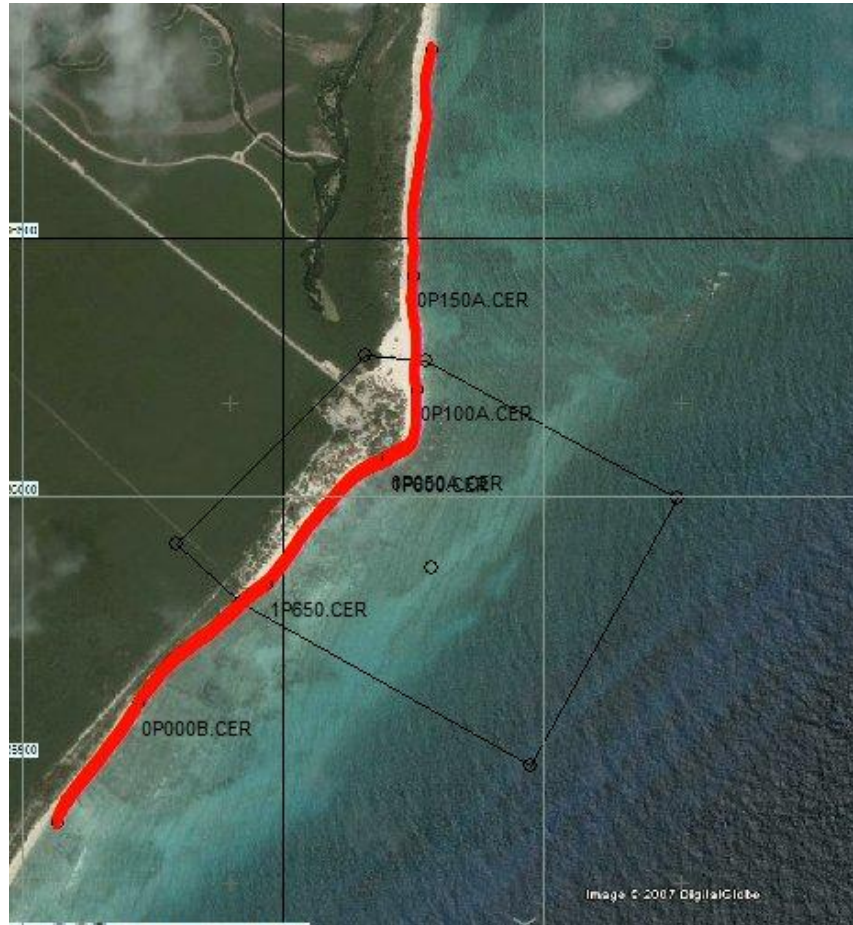
Figura 35. Línea cero obtenida caminando con GPS, puede apreciarse la excelente precisión que se obtiene sobre la foto satelital.
