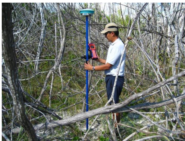
Figura 34. Registro de puntos en el terreno, la antena se alinea vertical por medio de un nivel integrado en el tubo de la antena.
