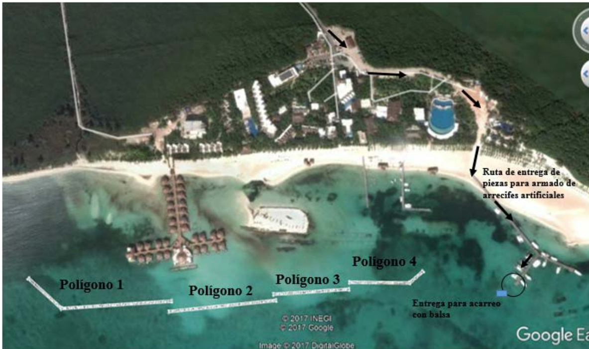
Figura 2.14.- Ruta de entrega de componentes que integran las piezas para la instalación de los arrecifes artificiales.
