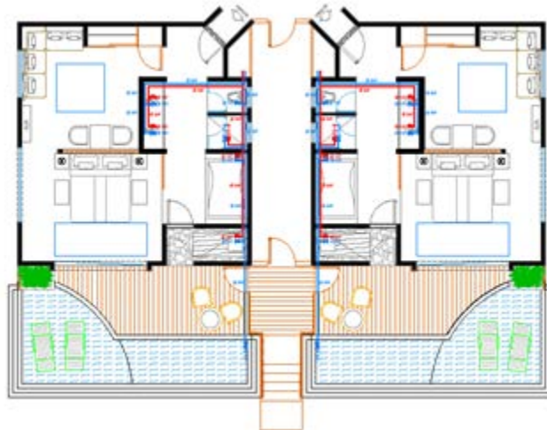
Figura 2.21 Instalación hidráulica en palafito
