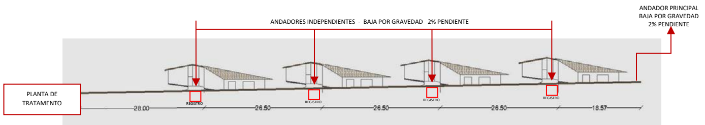
Figura 2.22. Sistema de recolección de aguas residuales por vacío.
