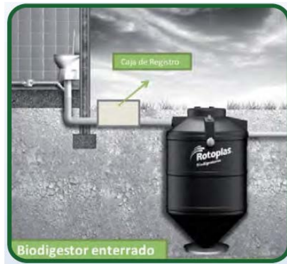
Figura 2.17.- Descripción del biodigestor.
