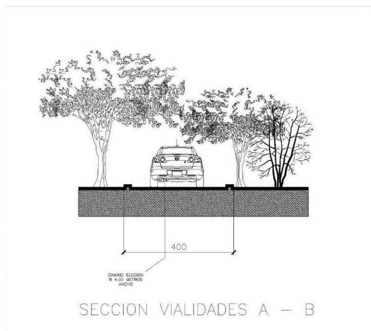
Figura II.27. Detalle de vialidad principal.
