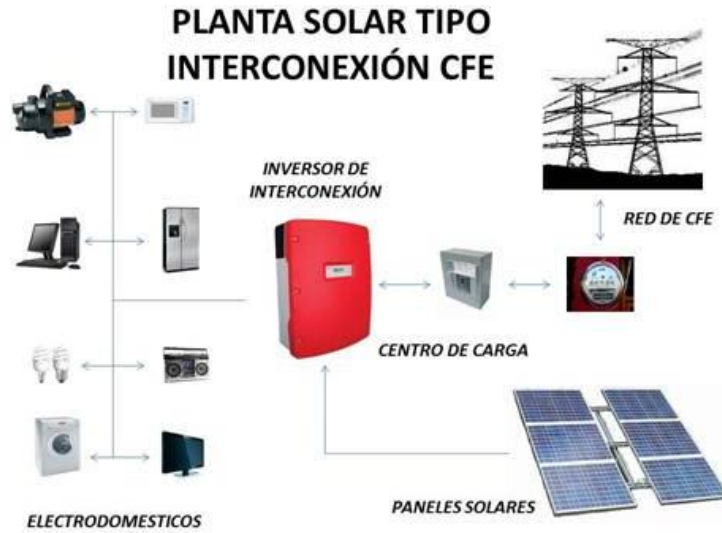
Figura III.6. Diagrama básico de generación y flujo de energía, incluyendo la fuente de energía alternativa que se incorpora al proyecto.
