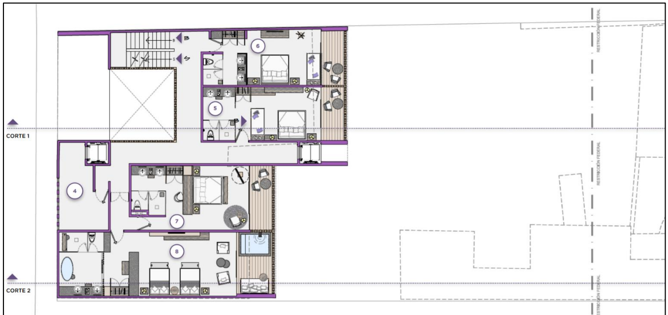
Figura 2.8. Plano arquitectónico del nivel 2.
